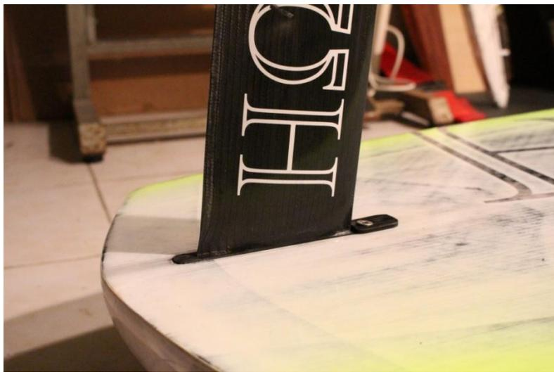
Pour enlever l'hydrofoil de la planche, il suffit de dévisser les vis du boîtier et de tirer très fermement vers le haut et/ou faire des petits mouvements vers l'avant et l'arrière. Ne pas utiliser d'outils.
