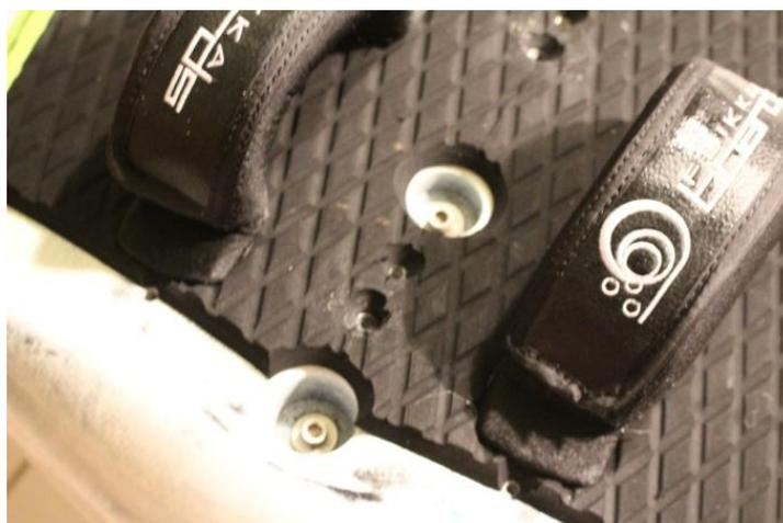
Le boîtier du foil doit alors arriver à ras de la carène et la butée de carène « plug and play » doit être au contact de celle-ci.
